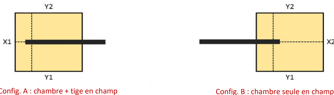
Fig 1. : Exemple de montage pour estimer le courant hors volume sensible.
